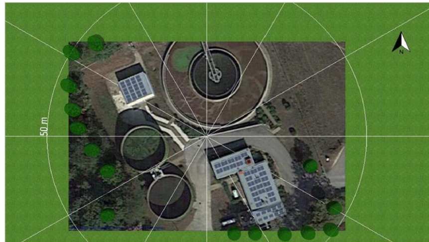
Bild 4: Layout der PV-Aufdachanlage in Ost-/ Westausrichtung Kläranlage der Stadt Baunach
